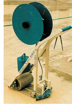
MÖRTELSCHLAMSCHABER FÜR EINE GENAUERE VERLEGUNG
