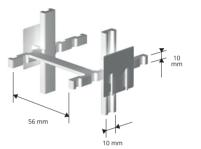
**DOPPY PACПОРКА С ДВОЙНЫМ СЛОТОМ** типа **DOPPY** позволяет удерживать одновременно две решетки с диаметрами от 4 до 10 мм на одинаковом расстоянии от опалубки
