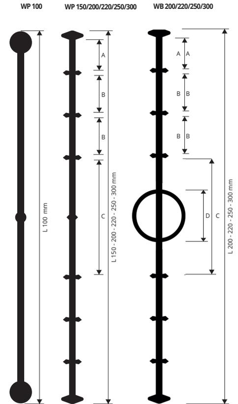
Профили для смежных бетонных укладок
