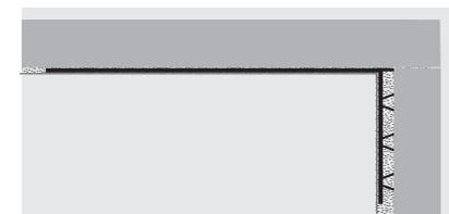
Profilé périmétrique pour la protection et la finition du bord externe de sols surélevés de différente nature, céramique, bois, marbre, etc. Le **PROSUPPORT PROFILE A & B** comprend une base plate horizontale en forme de «L» à insérer et à fixer au-dessus de la tête plate autonivelante du PROSUPPORT et une partie apparente verticale à insérer dans l'élément en forme de «L» vertical (comme indiqué sur le dessin).
