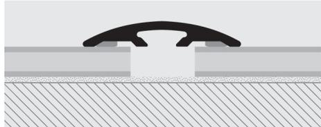
1. Wählen Sie SOL 30 selbstklebend im gewünschten Dekor. 2. Schneiden Sie das Profil auf die erforderliche Länge zu, säubern, entfetten und trocknen Sie die Fläche und stellen Sie sicher, dass die Aufbringtemperatur mindestens 15° iStk. 3. Ziehen Sie das Schutzpapier vom Klebestreifen ab und verlegen Sie das Profil unter gleichförmigem manuellem Andrücken, ohne das Profil dabei zu bewegen und Eisen-/Stahlhämmer zu verwenden.
