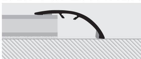
1. Wählen Sie ZERO CURVE selbstklebend im gewünschten Dekor. 2. Schneiden Sie das Profil auf die erforderliche Länge zu, säubern, entfetten und trocknen Sie die Fläche und stellen Sie sicher, dass die Aufbringtemperatur mindestens 15° iStk. 3. Ziehen Sie das Schutzpapier vom Klebestreifen ab und verlegen Sie das Profil unter gleichförmigem manuellem Andrücken, ohne das Profil dabei zu bewegen und Eisen-/Stahlhämmer zu verwenden
