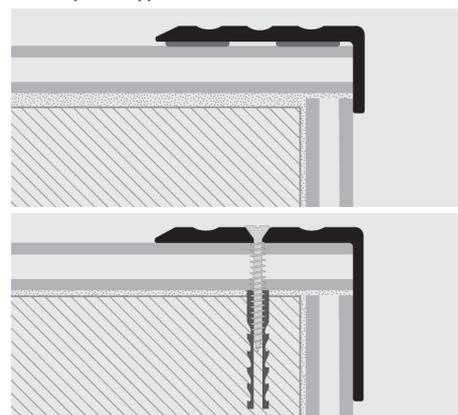
**PROSTEP INS** - это профиль защиты ступени из анодированного алюминия под серебро, который идеально подходит для защиты и кладки плавающих ступеней из ламинированной / меламиновой древесины и паркета. Имеются в наличие две высоты: 10,5 и 16.
