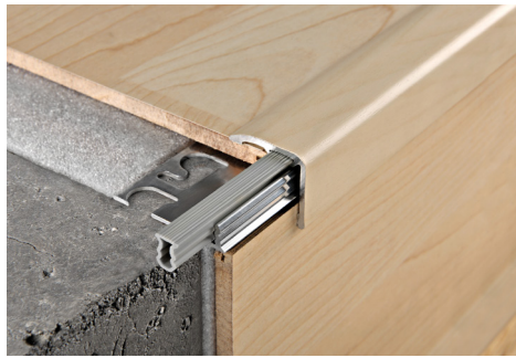
TOP ALU. + INSERT PIN + BASE 40 ALU. COUPÉE/PERFORÉE (6 finitions alu. anod. 3 sur demande) thermo packed long. b. 2,7 ML - cond. 20 Pces - 54 ML (H 14 - H 16 - H 18mm - 40,5 ML)
