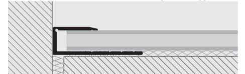
1. Выберите TERMINAL согласно требуемым параметрам высоты, и отделайте и зафиксируйте с помощью болтов и винтовых анкерных болтов или клеем/силиконом; профиль должен быть размещен рядом с примыкающими поверхностями, например: стена, застекленные участки, и т. д. 2. Подравняйте пол из клееной древесины/меламина/дерева, оставляя большой промежуток для естественного растягивания между полом и профилем (прибл. 3/10 мм с каждой стороны).
