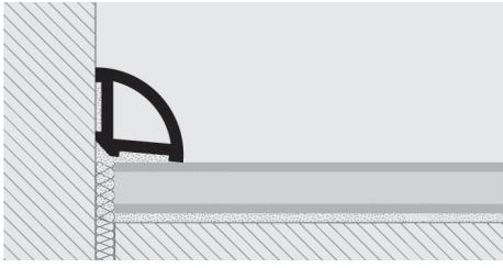
1. Choisir le PROANGLE WOOD de la couleur/de la finition bois souhaitée. 2. La pose doit être effectuée en utilisant du silicone acrylique à fixation rapide, du mastic, prévu pour coller le PVC avec mortier - plafonnage - parois équipées-etc. ou bien fixer avec des vis/clous.
