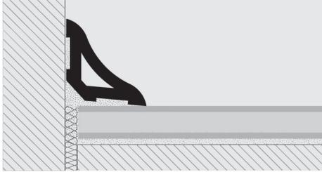
1. Choisir le PROSEAL WOOD de la couleur/de la finition bois souhaitée. 2. La pose doit être effectuée en utilisant du silicone acrylique à fixation rapide, du mastic, prévu pour coller le PVC avec mortier - plafonnage - parois équipées-etc. ou bien fixer avec des vis/clous
