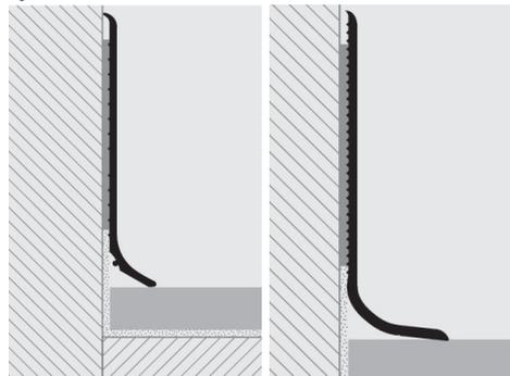
1. Elegir el "RODAPIÉ 60/120" en función del colore y de la altura requerida. 2. cortar el rodapé a la medida necesaria 3. colocar el perfil con el adhesivo idoneo.
