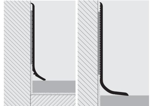
1. "SOCKELLEISTE 60/120" gemäß der Höhe und der gewünschten Farbe auswählen. 2. "SOCKELLEISTE 60/120" auf die gewünschte Länge zuschneiden. 3. Einen geeigneten Kleber auftragen und das Profil verlegen.
