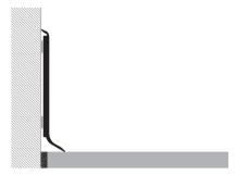
Dei "SOCKELLEISTE 6014/8014" in der gewünschten Farbe wählen. 2. "SOCKELLEISTE 6014/8014" in der gewünschten Länge zuschneiden. Verlegung mit PROBAND FIX. 3. Den Untergrund wo die Sockelleiste verlegt wird gründlich von Oel, Fett und Schmutz reinigen. 4. Wenn der Untergrund getrocknet ist PROBAND FIX anbringen. 5. Die Sockelleiste gegen die Wand, mit angemessener Kraft, pressen. 6. Verlegung mit Schrauben und Nägel.
