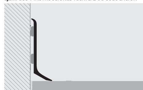
1. Elegir el "RODAPIÉ 40" en acabado requerido. 2. Cortar "RODAPIÉ 40" a la medida requerida. 3. Quitar esmeradamente de la superficie de colocación residuo de aceite, graso y suciedad en general. 4. Con la superficie seca aplicar la silicona (si el perfil tiene adhesivo, quitar la película de protección). 5. Apretar el perfil contra la pared. 6. Utilizar las piezas especiales para una colocación a la perfección.
