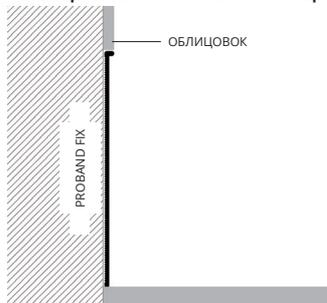
1. Закрепите PROSKIRTING LINE клеем/силиконом (под расположенной на виду стороной) перед выполнением выбранной облицовки, рассчитав высоты и расстояния.
