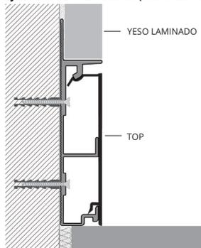
**PROSKIRTING FLAT** es un rodapié con soporte agujereado de aluminio natural para fijar a las paredes con tacos y un perfil a vista, para fijar al soporte, disponibles en los acabados aluminio anodizado, cepillado y barnizado. El rodapié es apto al paso de cables a baja tensión como cables de red, telefónicos, TV y por satélite, tiene también un ángulo exterior. **PROSKIRTING FLAT** de aluminio se puede usar rodapié en cualquier ambiente interior.
