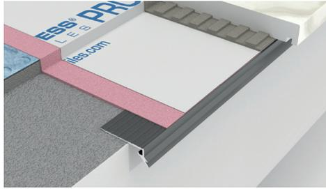
**PROTERRACE UNDER EDGE L** Lackiertes Aluminium
