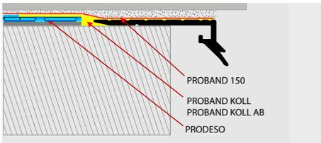
**VERLEGUNG UNTER DER FLIESEN ODER MARMOR:** 1. Wählen Sie PROTERRACE UNDER EDGE L auf Grund der gewünschten Farbe 2. PROTERRACE UNDER EDGE L auf die gewünschte Länge zuschneiden und mit Nägel auf den Untergrund befestigen in dem Sie 2 mm Abstand zwischen den Profilen lassen 3. Das gewünschte Abdichtungssystem verlegen 4. den Bodenbelag verlegen 5. Die Verbinder einbauen und mit PROBAND FIX kleben.
