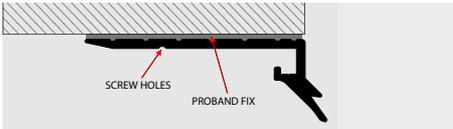
**EINBAU AN DER KANTE VON UNTEREN TERRASSEN UND BALKONE:** 1. Wählen Sie PROTERRACE UNDER EDGE L auf Grund der Farbe 2. PROTERRACE UNDER EDGE L auf die gewünschte Länge zuschneiden und mit PROBAND FIX verkleben und Schrauben befestigen in dem Sie 2 mm Abstand zwischen den Profilen lassen 3. Die Verbinder einbauen und mit PROBAND FIX kleben.
