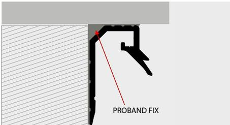
1. Wählen Sie PROTERRACE UNDER EDGE C auf Grund der gewünschten Farbe 2. PROTERRACE UNDER EDGE C auf die gewünschte Länge zuschneiden 3. Das Profil mit PROBAND FIX verkleben und Schrauben befestigen in dem Sie 2 mm Abstand zwischen den Profilen lassen 4. die Verbinder einbauen und mit PROBAND FIX kleben.
