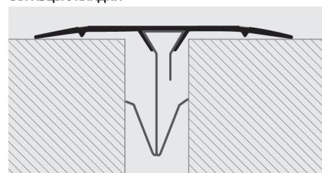
**PROPLATE FIX** – серия покрывающих профилей для покрытия структурных перемещений и растяжения (усадка изгиб - усадка сжатие) двух различных несущих структур.
