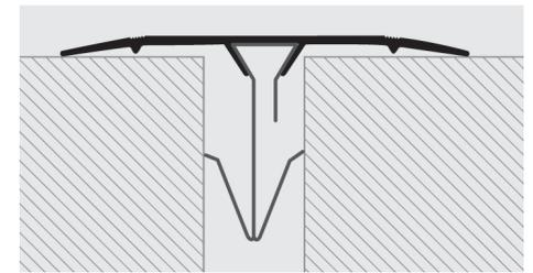
**PROPLATE FIX** ist eine Fugenabdeckung aus steifem, stoßfestem und ungiftigem Vinylharz, hinten mit einer schwalbenschwanzförmigen Vertiefung ausgestattet, in welche Stahlclips zur Befestigung eingesetzt werden. **PROPLATE FIX** aus steifem, stoßfestem und ungiftigem Vinylharz, ist als Fugenabdeckung in Umgebungen geeignet, die dem Fußgängerverkehr / Fahrzeugverkehr mit Gummirädern ausgesetzt sind.
