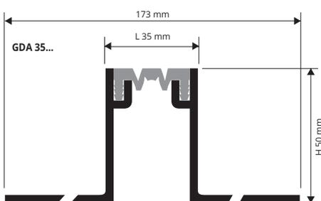
1. Scegliere "GDA 25 - 35" in funzione del colore. 2. Fissare le alette traforate del profilo alla struttura con tasselli ogni circa 30 cm. 3. Fare il massetto e posare le piastrelle avendo cura di allinearle al profilo lasciando una fuga di circa 1 mm tra profilo e piastrelle. Il giunto, a posa ultimata, deve essere sempre posizionato 0,5 mm al di sotto della superficie della pavimentazione. 4. Stuccare accuratamente le fughe tra profilo e piastrelle onde evitare il ristagno di eventuale acqua.
