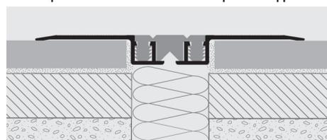
Закрепите боковые выступы/фланцы из алюминия с 1. Болты и винтовые анкерные болты по интервалам в 20 см по обеим сторонам всего шва. 2. Две упаковки клеящего средства из эпоксидной смолы или с сильным быстро закрепляющимся силиконом.
