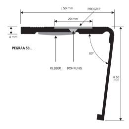
**PROEND 5050** ist ein trittsicheres Profil für Treppen aus eloxiertem Aluminium Silber. Es besteht aus einem horizontalen gerillten Teil, an welchem der Carborundum-Film angebracht wird, und aus einem geneigten Teil mit perfekt glatter Oberfläche. Das Profil ist verfügbar mit Kleber, gelocht und zur Befestigung mit Dübeln. **PROEND 5050** aus eloxiertem Aluminium eignet sich für jede Art von Treppe in Innenbereichen mit Verkleidung mit geringer Stärke.
