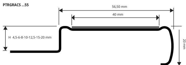
EDELSTAHL INOX AISI 304/1.4301-V2A SATINIERT mit Schutzfolie - Stangenlänge 2,7 Lfm - Höhle 36,50 mm
