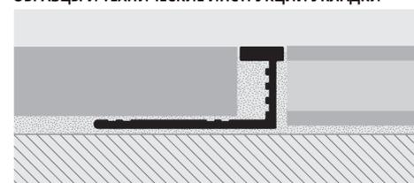
1. Выбрать PROELEGANT CURVE с необходимой высотой и материалом. 2. Порезать профиль до необходимой длины, учитывая общую длину. 3. Согнуть профиль механически с помощью PROCURVE MACSHINE. 4. В случае необходимости зафиксировать винтами и якорями винта или просто вставить перфорированную основу под пол, уложенную тем же клеящим средством. Любые следы окисления могут быть легко удалены определенными химическими веществами (Сидол-Смак, и др.).
