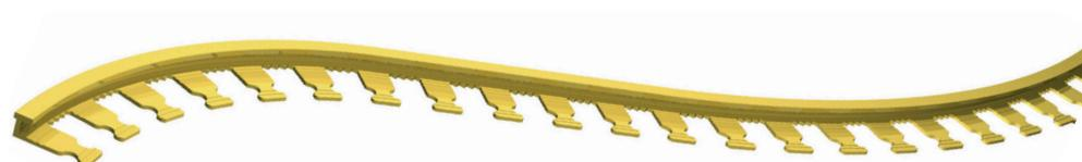
**PROTERMINAL CURVE** - серия сгибаемых/трафаретных окантовочных и разделительных профилей со специальной деформируемой штамповкой, позволяющей легко выкладывать необычные геометрические формы, создавая декоративные рисунки по вкусу в соответствии с техническими и эстетическими потребностями с разделением 6 мм. Сделан из алюминий анодированный серебро длина 2.7 м, высота 8-10-12.5 мм.
