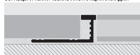
1. Выбрать PROELEGANT CURVE с необходимой высотой и материалом. 2. Порезать профиль до необходимой длины, учитывая общую длину. 3. Согнуть профиль механически с помощью PROCURVE MACSHINE. 4. В случае необходимости зафиксировать винтами и якорями винта или просто вставить перфорированную основу под пол, уложенную тем же клеящим средством. Любые следы окисления могут быть легко удалены определенными химическими веществами (Сидол-Смак, и др.).
