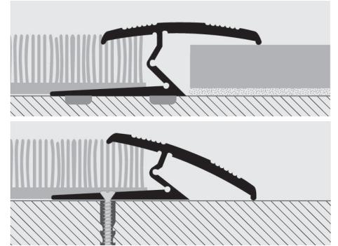
1. Couper le profilé à la longueur nécessaire. 2. Fixer le **PROMOQUETTE GIN** au sol à l'aide de vis/clous ou d'adhésif double face/scotch. 3. Poser le revêtement désiré en introduisant la moquette, le pvc, le linoléum, la céramique ou le bois sous la partie supérieure courbée du profilé. 4. Ecraser le profilé en pressant de manière uniforme de manière à ce que le profilé couvre des deux côtés, au ras du revêtement.
