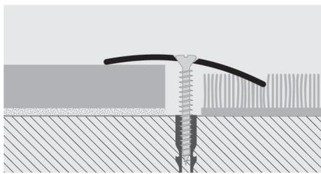
1. Выберите подходящий профиль и отрежьте его по необходимой длине. 2. Отметьте положение отверстий, используя существующие отверстия в профили как пример. 3. Вставьте винтовые анкерные болты в просверленные отверстия. 4. Зафиксируйте профиль используя болты с плоскими наконечниками, подходящие для соответствующих щелей в профиле.
