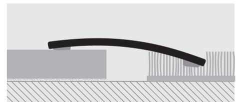
1. Je nach Breite "PROSOL 18-30-35-40" auswählen. 2. "PROSOL 18-30-35-40" auf gewünschte Länge schneiden. 3. Die Auflagefläche von Ölen, Fetten und Schmutzigkeit reinigen. 4. Wenn die Auflagefläche trocken ist, die Silikonfolie entfernen, die Trockenheit prüfen, das Profil drücken ohne einschlagen.
