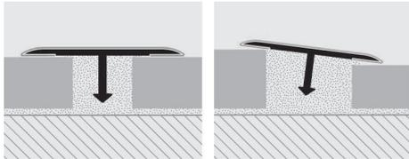
1. Escoger "PROCOVER" en función de la distancia entre las baldosas colocadas y tener en cuenta que el apoyo del perfil tiene que ser de 2 a 3 mm en cada parte. 2. Rellenar la junta entre las baldosas con silicona o con el cemento cola utilizado para la colocación del pavimento. 3. Encajar el perfil entre las baldosas hasta que el perfil esté perfectamente apoyado a ambos lados.
