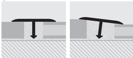
1. Escoger "PROCOVER" en función de la distancia entre las baldosas colocadas y tener en cuenta que el apoyo del perfil tiene que ser de 2 a 3 mm en cada parte. 2. Rellenar la junta entre las baldosas con silicona o con el cemento cola utilizado para la colocación del pavimento. 3. Encajar el perfil entre las baldosas hasta que el perfil esté perfectamente apoyado a ambos lados.
