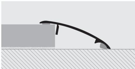
1. Je nach Oberflächendekor "PROTRANS" auswählen. 2. "PROTRANS" auf gewünschte Länge schneiden. 3. Die Auflagefläche von Ölen, Fetten und Schmutzigkeit reinigen. 4. Wenn die Auflagefläche trocken ist, die Silikonfolie entfernen, die Trockenheit prüfen, das Profil drücken ohne einschlagen.
