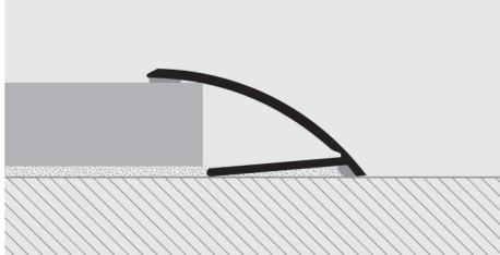
1. Je nach Oberflächendekor "PRONIVO" auswählen. 2. "PRONIVO" auf gewünschte Länge schneiden. 3. Die Auflagefläche von Ölen, Fetten und Schmutzigkeit reinigen. 4. Wenn die Auflagefläche trocken ist, die Silikonfolie entfernen, die Trockenheit prüfen, das Profil drücken ohne einschlagen.
