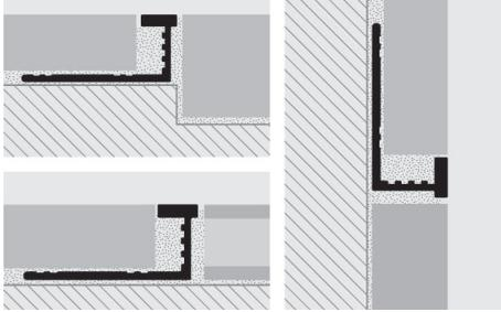
1. La hauteur du "PROELEGANT" choisi doit correspondre à l'épaisseur du revêtement/sol. 2. Recouvrir de colle la zone d'application du profilé. 3. Appliquer et aligner le profilé en pressant l'ailette perforée dans la colle. 4. Poser les carreaux en les alignant de manière à ce qu'ils coïncident parfaitement avec la partie supérieure du profilé. Remplir complètement de colle les éventuels interstices qui se sont formés.
