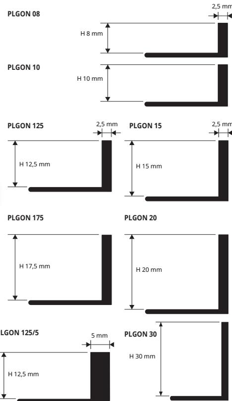
Les **PROLEVIGAL** sont des profilés de séparation employés pour créer le joint technique sur les sols spéciaux comme marbre vénitiens- typologie 'Palladio', qui doivent être polis après la pose. La spéciale forme en 'L' à la base coupée/perforée et le bord vertical d'épaisseur 2,5 mm permettent un dressage parfait et l'uniformité d'épaisseur. L'article est produit en aluminium naturel et laiton naturel en différentes épaisseurs et aussi en variante façonnable PROLEVIGAL CURVE ALU.
