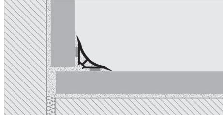
1. Choisir le PROSEAL de la couleur et du type désiré. 2. Nettoyer la surface d'appui et s'assurer qu'elle ne soit ni grasse ni humide. Une température supérieure à 15° est conseillée pour l'application.
