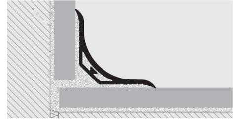
1. Choisir le PROSEAL de la couleur et du type désiré. 2. Nettoyer la surface d'appui et s'assurer qu'elle ne soit ni graisse ni humide. Une température supérieure à 15° est conseillée pour l'application. 3. Enlever le papier de protection de l'adhésif puis poser délicatement le raccord, sans marteler, en pressant de manière uniforme. 4. Utiliser les raccords internes-externes-à trois voies dans les angles en fixant toujours avec du silicone.
