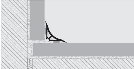
1. Elegir "PROSEAL 25" en función del color requerido. 2. Cortar "PROSEAL 25" a la medida necesaria. 3. Limpiar la superficie sobre todo de aceites y grasas. 4. Quitar la cinta de protección del adhesivo y después de haber averiguado que la superficie sea seca, colocar el perfil y presionar y golpear; en el caso de utilizar la versión sin adhesivo, aplicar la silicona al soporte limpio y seco y colocar el perfil presionando sin golpear.
