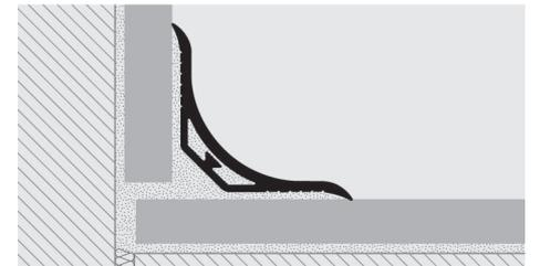
1. Elegir "PROSEAL 50" en función del color requerido. 2. Cortar "PROSEAL 50" a la medida necesaria. 3. Limpiar la superficie sobre todo de aceites y grasas. 4. Quitar la cinta de protección del adhesivo después de haber averiguado que la superficie sea seca, colocar el perfil y presionar y golpear; en el caso de utilizar la versión sin adhesivo, aplicar la silicona al soporte limpio y seco y colocar el perfil presionando sin golpear.
