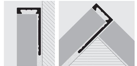
**PROTERMINAL** ist ein Winkelprofil aus ungiftigem stoßfestem farbigem Vinylharz. Es ist geeignet für den Kantenschutz von Verkleidung und als äußerer Abschluß. Sein besonderer offener Schnitt, die verschiedene Oberflächendekors auch auf Anfrage machen **PROTERMINAL** ein hochwertiges Profil für eine kunstgerechte Verlegung.
