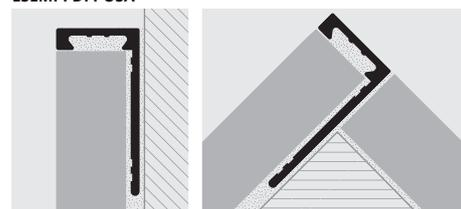
**PROTERMINAL** è un profilo in alluminio naturale e anodizzato a forma di "L" idoneo a proteggere gli angoli esterni dei rivestimenti, come chiusura perimetrale dei rivestimenti, come profilo di raccordo traalzata e pedata nelle scale rivestite in ceramica e pietre naturali e come profilo di separazione a parete e pavimento. La sua particolare sezione e la disponibilità in sei diverse finiture rendono **PROTERMINAL** un profilo molto ricercato che consente una posa a regola d'arte.
