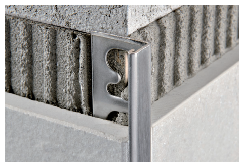
ПОЛИРОВАННАЯ НЕРЖ. СТАЛЬ AISI 316-1.4401-V4A с защитной пленкой длина бруска 2,7 Лин.М - упак. 40 шт. - 108 Лин.М - 10/10 мм
