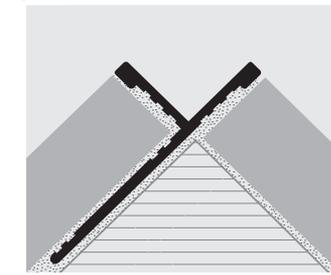
1. Elegir Proterminal Int en función de el espesor de la baldosa y de el acabado requerido. 2. Cortar Proterminal Int a la medida necesariay aplicar el cemento cola al soporte donde se tendrá que colocar el perfil. 3. Presionar la aleta del perfil Proterminal Int en el cemento cola. 4. Colocar la baldosa poniendolas debajo de la parte concáva del perfil. 5. Rejuntar entre baldosa y perfil para evitar que se filtre el agua.
